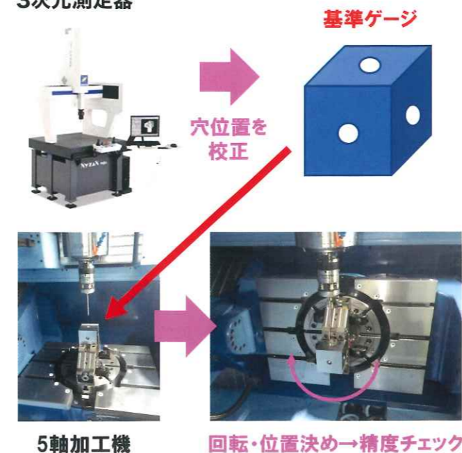
図2 3次元測定機で校正された基準ゲージによる5軸加工機の精度改善
